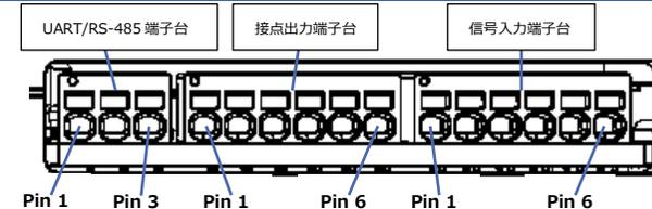
NailEdgeは信号入力端子台、接点出力端子台、UART/RS-485端子台を搭載しております。
